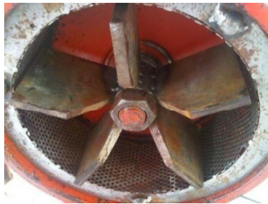
Gambar 1 Hammer mill (sumber: foto jalu)
